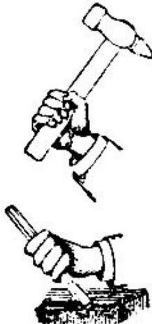
Рис. 83. Работа с зубилом
